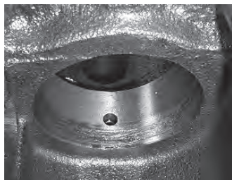
油膜切れによる カム軸受け異常摩耗
