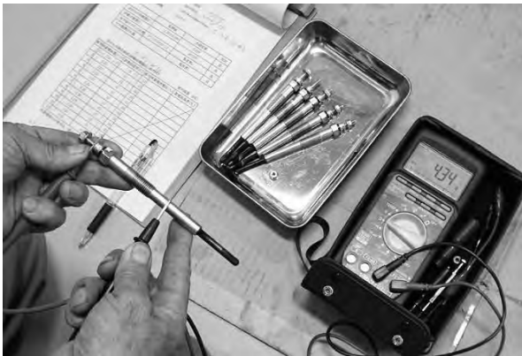
図7.1.1 予熱栓の点検例
