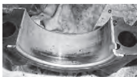
油膜切れによるクランク ピン軸受け摩耗兆候
