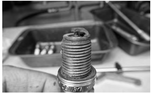
図7.1.2 点火プラグの点検例
