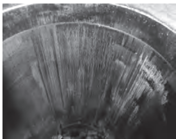
油膜切れによる シリンダライナの焼き付き
