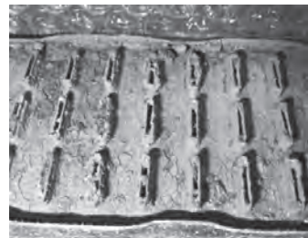
ラジエータ冷却水通路スケール 堆積による流路閉塞
