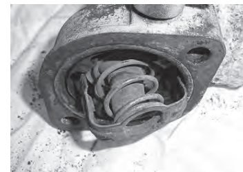
冷却水サーモスタット 発錆による破損
