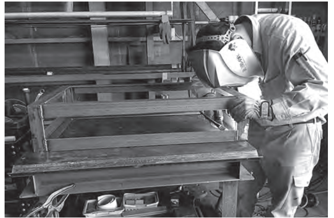
製函の溶接作業
