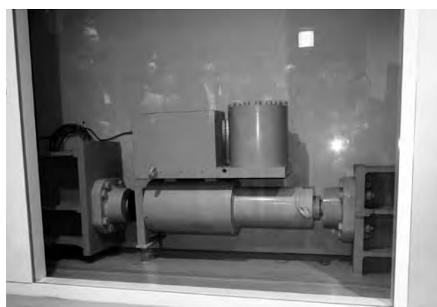
写真6 制震装置（HiDAX-R）の外観
