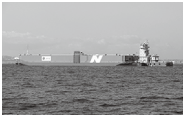
非自航船(バージ船。関東地方整備局HPより)
