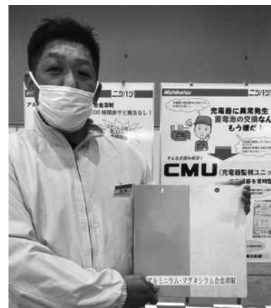
鉄板にアルミニウム・マグネシウム合金溶射を施した上で標準塗装を施した（左半分）
