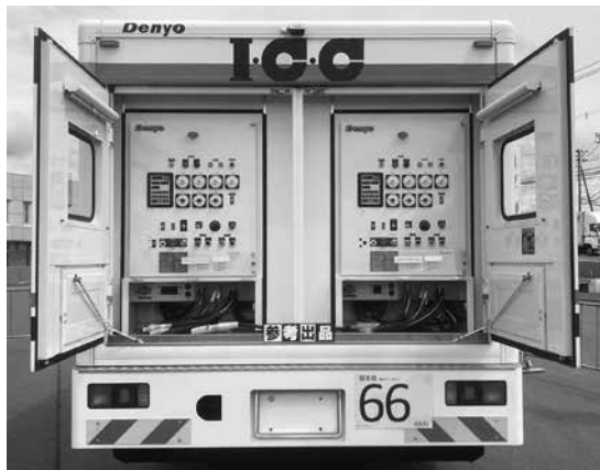
トラックタイプの移動電源車
