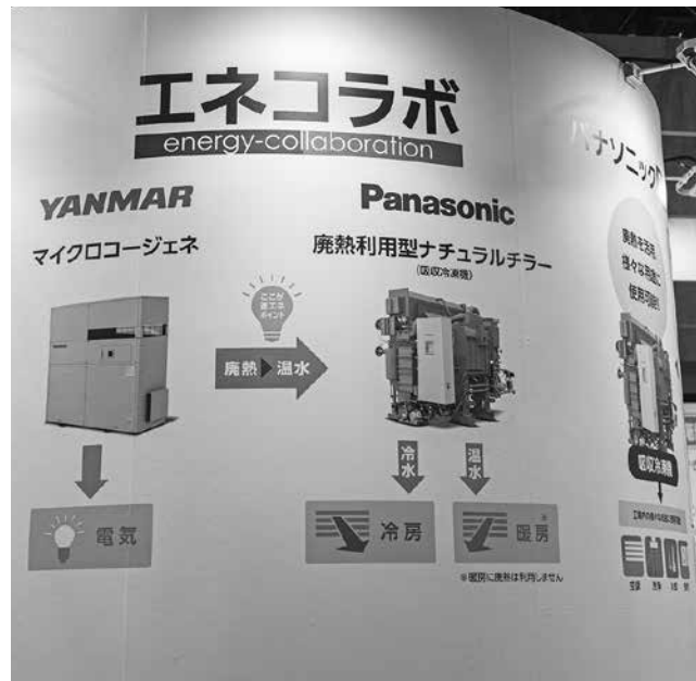
ヤンマーのガスコージェネとパナソニックの廃熱利用型吸収冷凍機を最適し省エネ省CO 2 を実現
